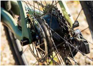
Kletterfreudiger Italiener: der Hecknabenmotor HM1 von FSA.
